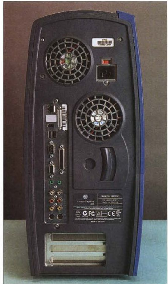
Il retro della SGI 320. Possiamo notare il completo set di connettori sulla sinistra, i tre slot PCI64 (nessuno occupato) in basso, la maniglia per lo sblocco del pannello laterale al centro, le due griglie per le ventole di aerazione e il singolo connettore per l'alimentazione.
